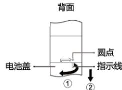
1. 将电池盖按 ① 的方向拧开至指示线对齐。
