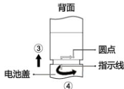
3. 将电池盖按 ③ 的步骤装上，此时指示线应与箭头底部对齐。
